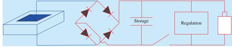
利用環境中的振動或轉動等動能，透過壓電能量擷取器輔以電路儲能系統設計，將機械振動能轉換為電能並加以儲存
